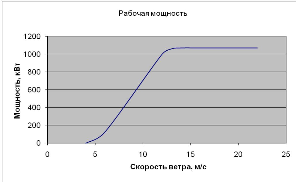
Рисунок 1. Зависимость рабочей мощности ВЭУ от скорости ветра
