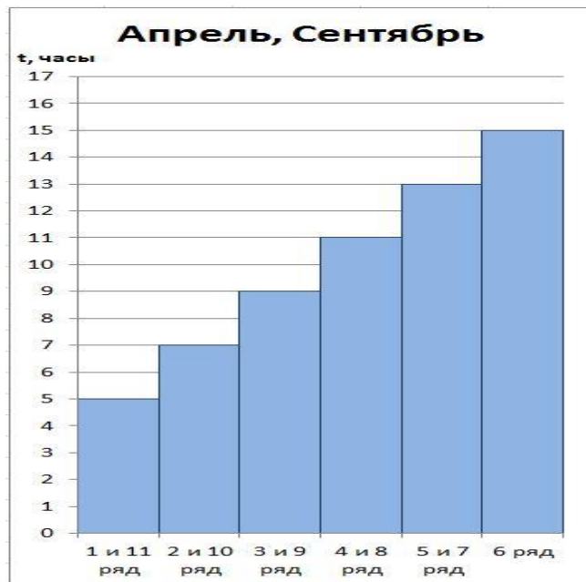
Рисунок 2. Зависимость времени работы рядов светильников от времени суток для месяцев: апрель, сентябрь
