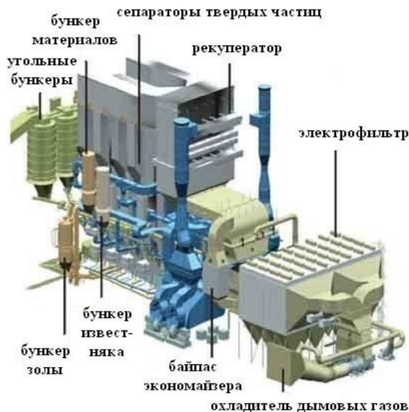
Рисунок 1 – Котел с ЦКС Áagisza [2]
