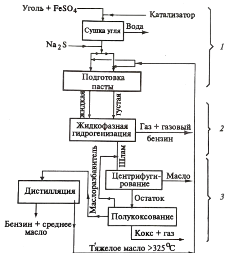
Рисунок 1 – Схема жидкофазной гидрогенизации угля
