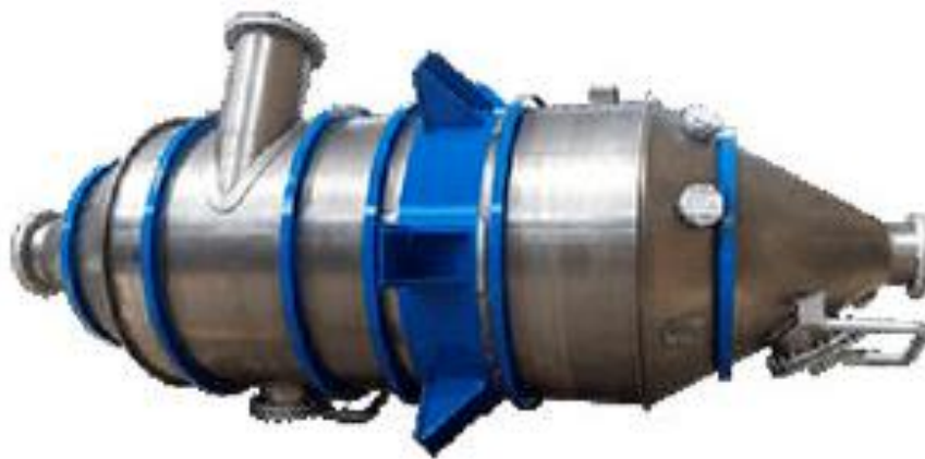
Рисунок 3 – Испаритель с принудительной циркуляцией [2]
