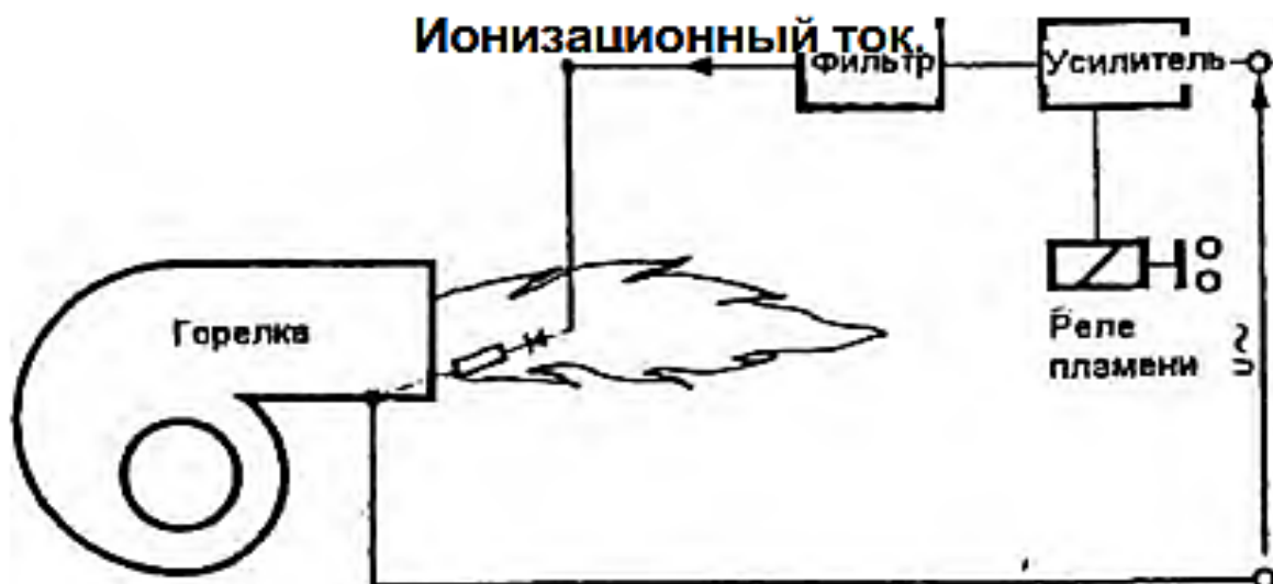
Рисунок 1 – Принцип действия датчика ионизации.
