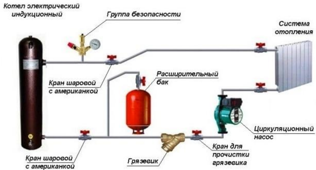
Рисунок 3 – Схема установки электрического котла для домашнего отопления [2]
