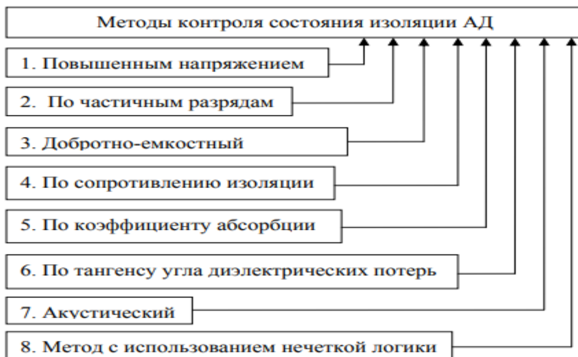
Рисунок 1. Методы контроля состояния изоляции АД
