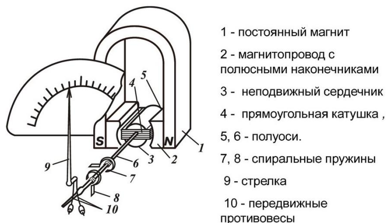
Рисунок 2 - Строение магнитоэлектрического механизма
