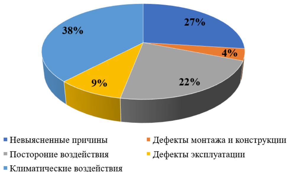
Рисунок 2 – Распределение отказов основных элементов воздушной линии 35-500 кВ по причинам в процентах к общему числу отказов [2]
