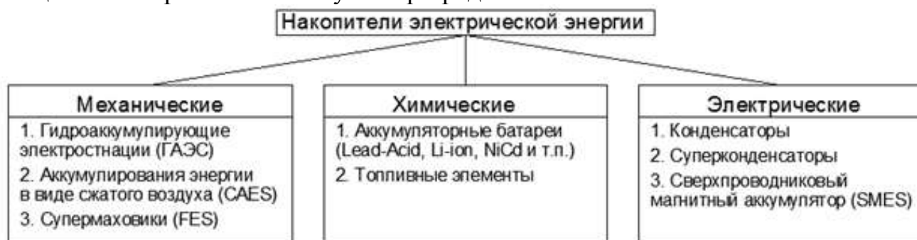
Рисунок 2. Накопители электрической энергии
