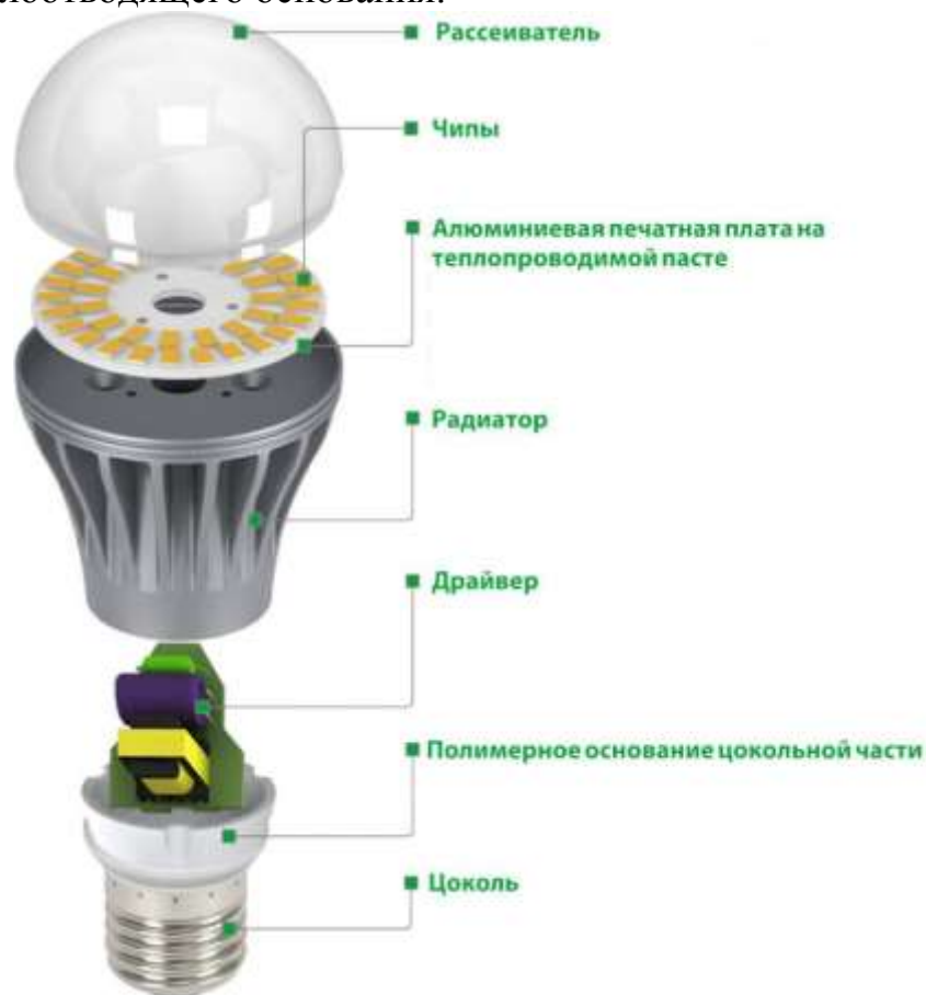
Рисунок 1 – Конструкция светодиодной лампы
