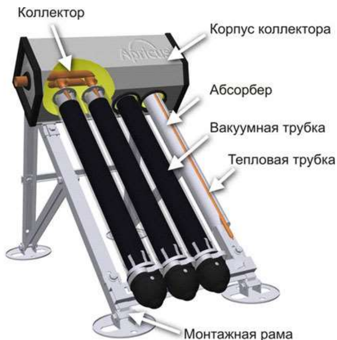
Рисунок 2 – Общий вид вакуумного гелиоколлектора
