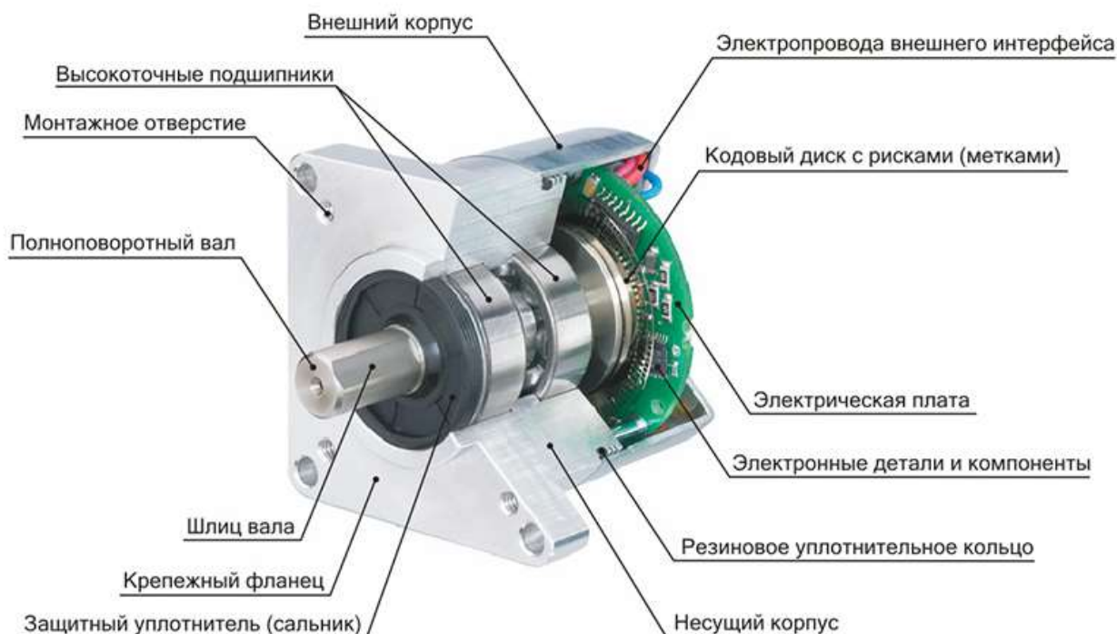
Рисунок 1. Устройство энкодера
