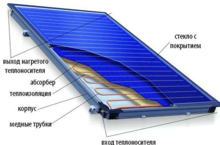
Рисунок 3 – Общий вид плоского гелиоколлектора
