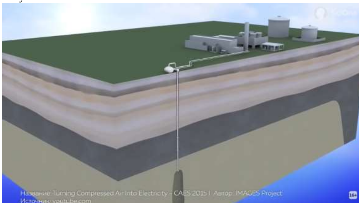
Рисунок 2 Аккумулирующая электростанция использующая сжатый воздух
