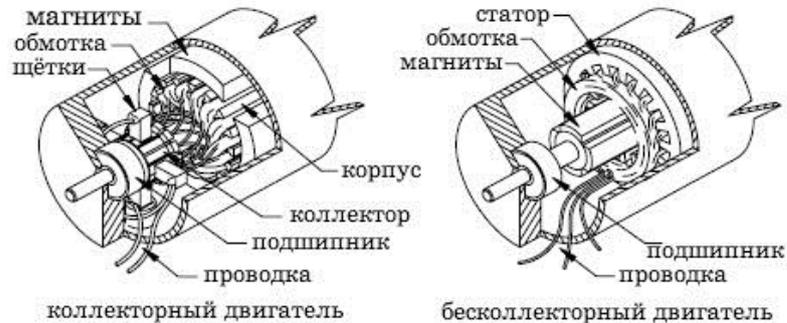
Рисунок 3 – Конструктивные отличия бесколлекторного двигателя и коллекторного двигателя
