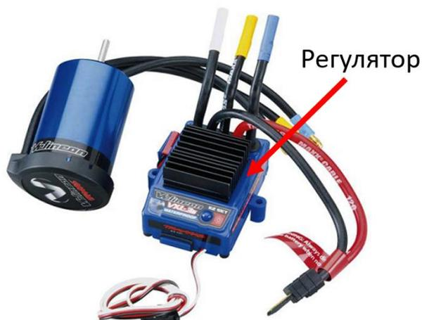
Рисунок 7. Регулятор как элемент управления бесколлекторным электродвигателем
