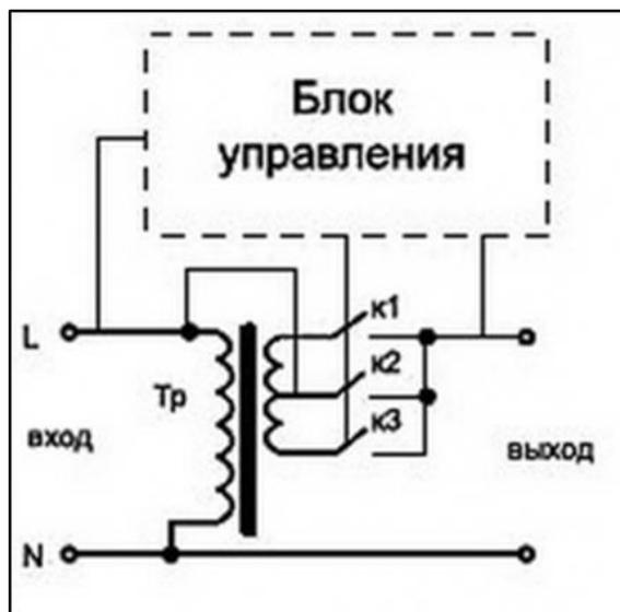
Рис.3 - Релейный стабилизатор напряжения. Схема функциональная
