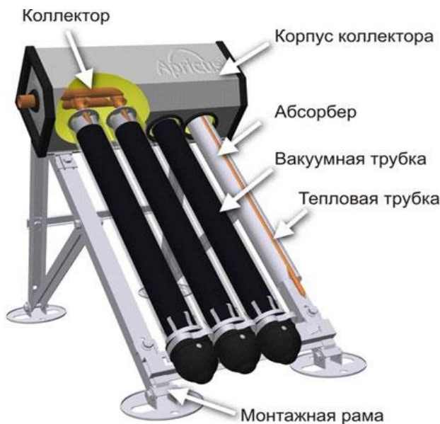
Рисунок 2. Вакуумный солнечный коллектор с разрезами.
