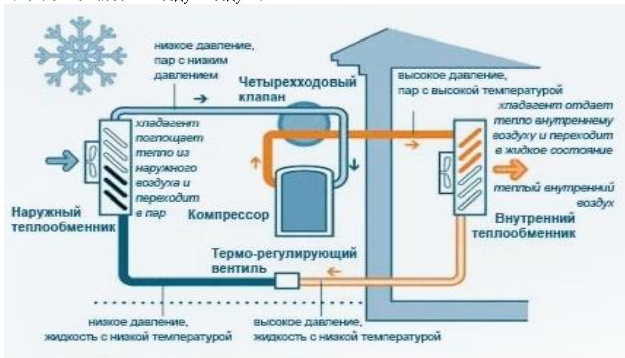
Рисунок 2. Устройство и принцип работы теплового насоса «Воздух-воздух».
