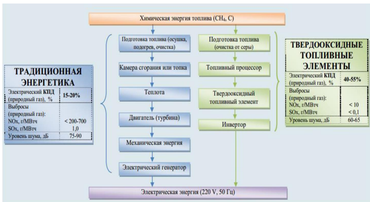
Рисунок 3. Преобразование энергии топлива в электрическую энергию с применением ТОТЭ
