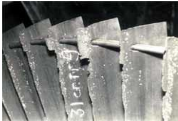
Рисунок 1. Вид эрозионно-разрушенных лопаток
