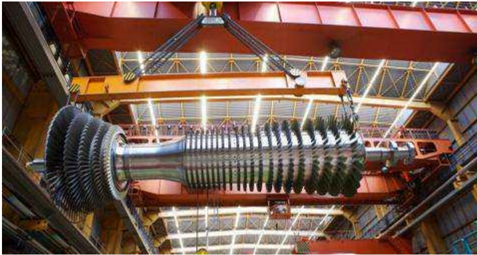
Рисунок 4. Испытуемый ротор подвешен на траверсе
