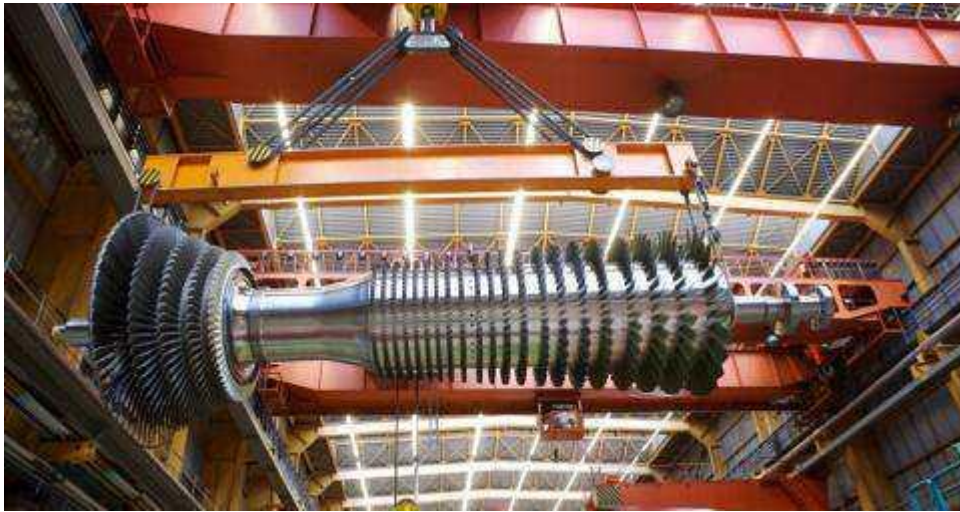
Рисунок 4. Испытуемый ротор подвешен на траверсе
