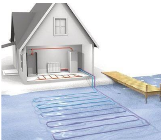
Рисунок 4. Горизонтальный водный контур теплового насоса
