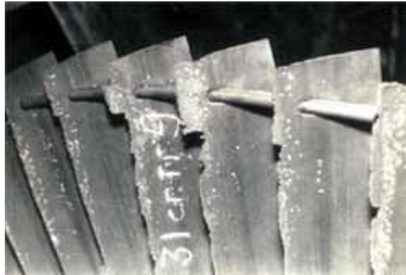
Рисунок 1. Вид эрозионно-разрушенных лопаток
