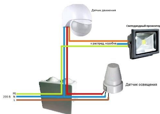
Рисунок 4. Схема подключения датчика движения и датчика освещения
