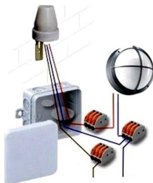
Рисунок 2. Схема подключения датчика
