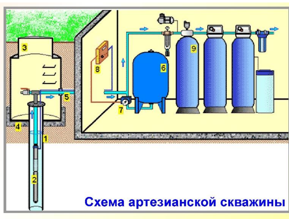
Рисунок 3. Схема артезианской скважины
