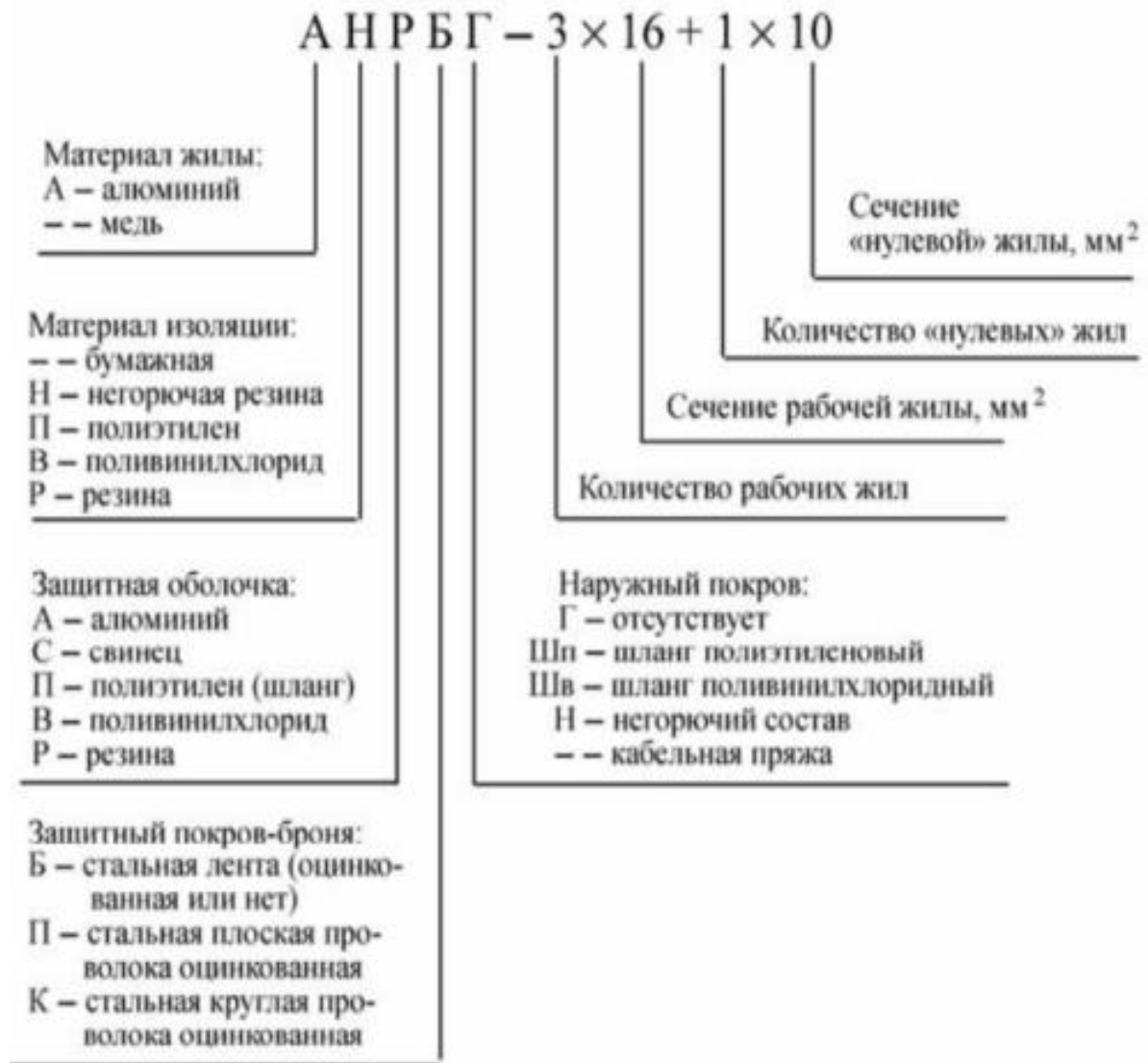
Рисунок 1 Маркировка силовых кабелей
