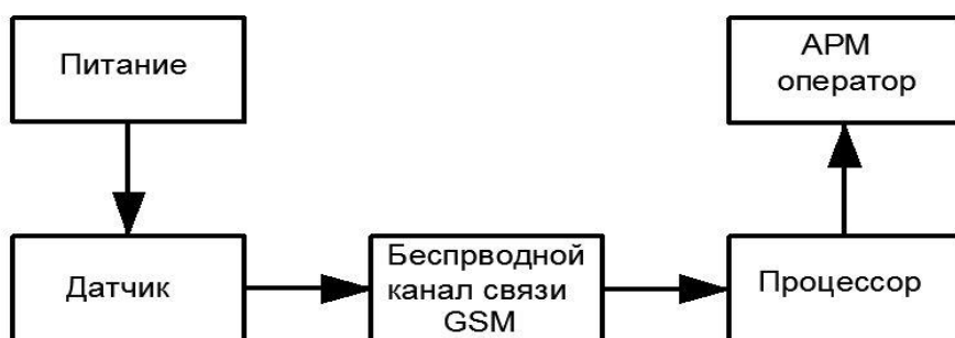
Рисунок 2 – Блок схема передачи измеренных данных оператору.
