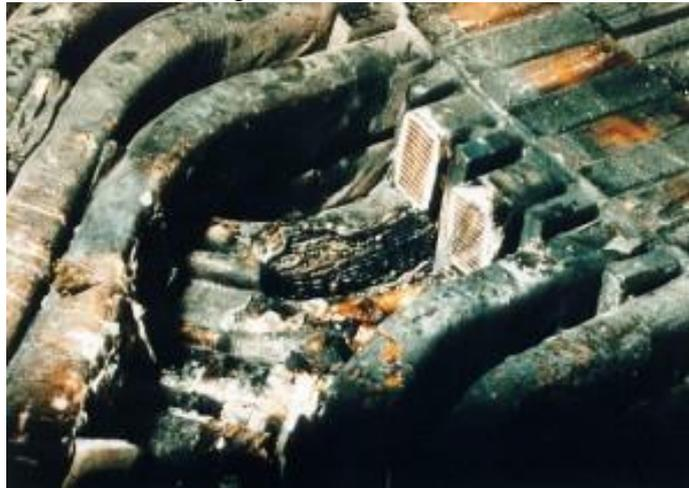
Рисунок 1. Повреждения изоляции обмоток статора
