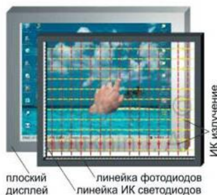
Рисунок 8. Устройство инфракрасного сенсорного экрана
