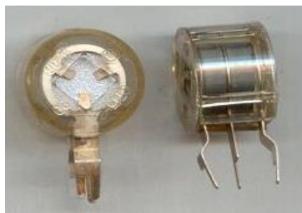
Рисунок 6. Внешний вид резистора СТ15-2-220В с косвенным подогревом
