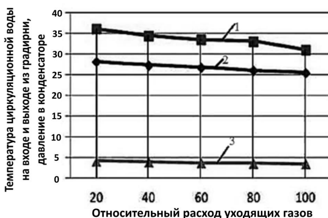
Рисунок 2. Изменение показателей работы ПГУ в зависимости от относительного расхода уходящих газов через градирню: 1, 2 – температура циркуляционной воды на выходе и входе градирни, °C; 3 – давление в конденсаторе, кПа; 4 – относительная влажность воздуха, %; 5 – самотяга градирни, Па
