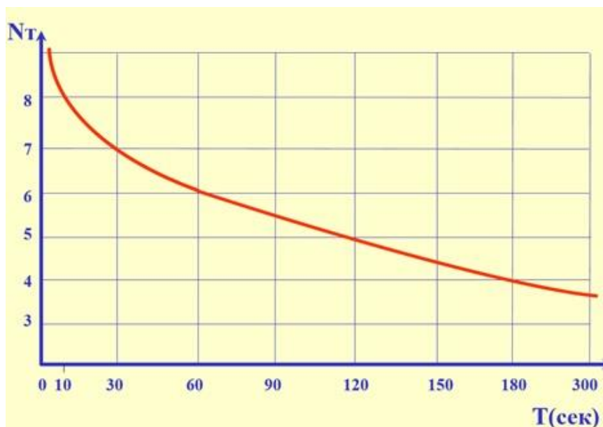
Рисунок 1. Остаточные тепловыделения РУ после срабатывания АЗ
