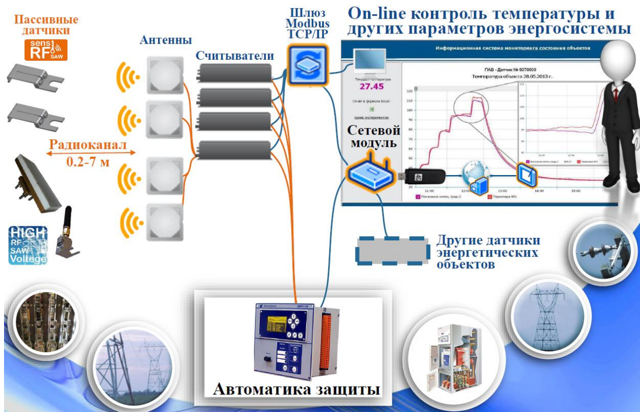
Рисунок 4 – Система мониторинга температуры высоковольтных узлов электрооборудования компании «ПАВ Лаборатория»
