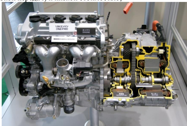
Рисунок 2 Гибридный двигатель параллельного соединения (разрез).
