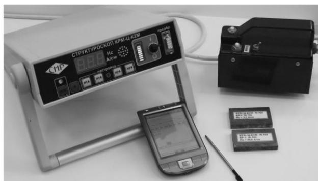
Рисунок 1 – Комплект оборудования для оценки напряженного состояния металла
