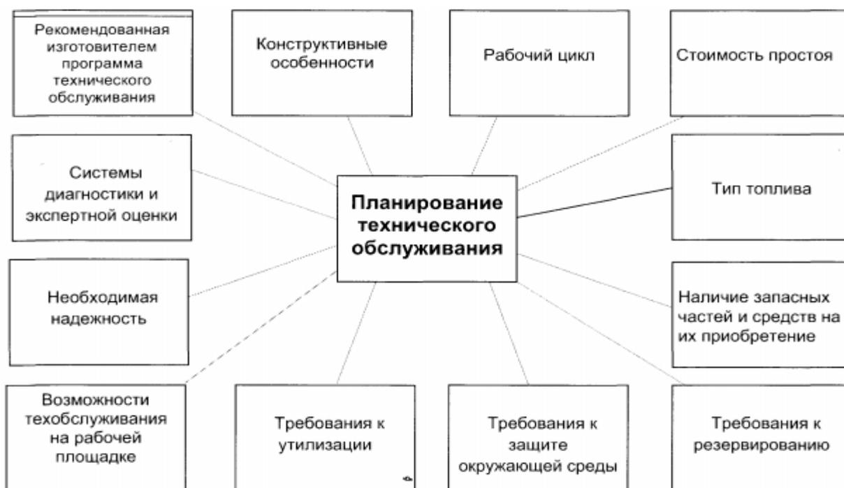
Рисунок 1 – Факторы, влияющие на планирование технического обслуживания ГТУ
