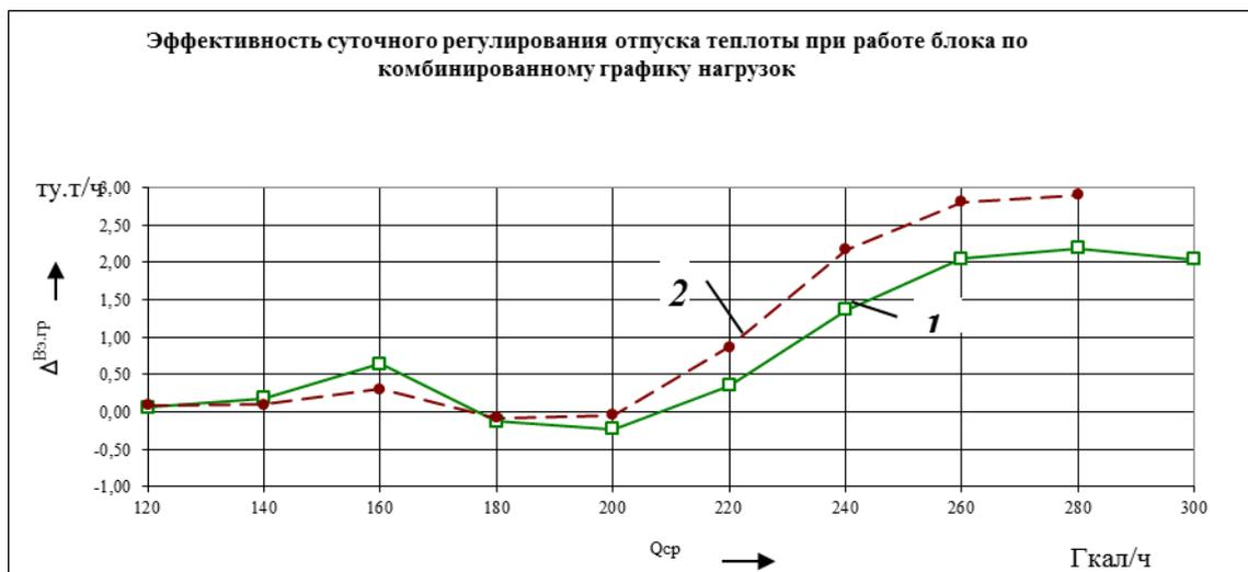
Рисунок 2 – Экономия топлива в энергосистеме за счет суточного регулирования при работе теплофикационного блока 250 МВт по комбинированному графику нагрузок:
