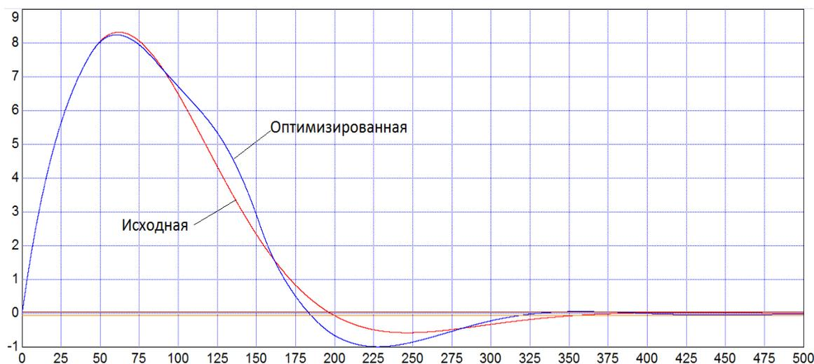
Рисунок 5 – График отработки внешнего возмущения конечным впрыском
