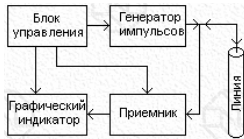
Рисунок 1 – Упрощенная структурная схема импульсного рефлектометра
