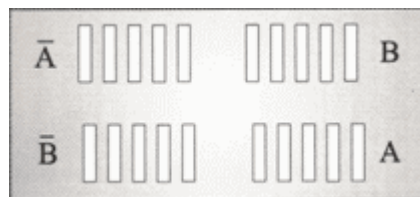
Рисунок 3. Схема преобразователя угловых перемещений
