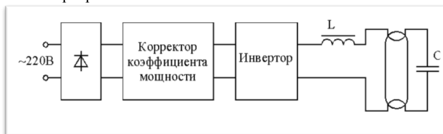
Рисунок 1. Силовая блок-схема ЭПРА.
